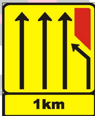
Desvio e diminuição de via de trânsito à esquerda
